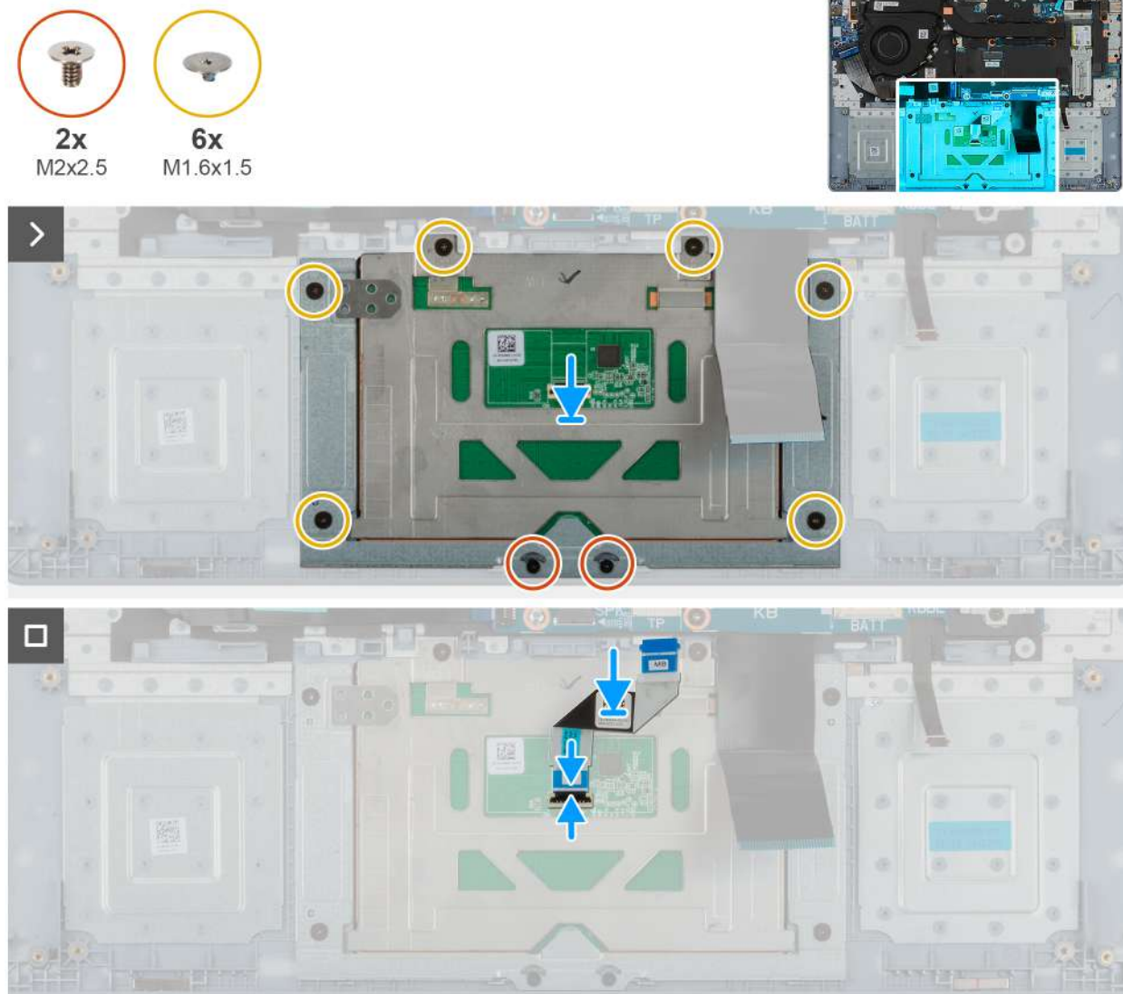
Rysunek 53. Instalowanie touchpada
