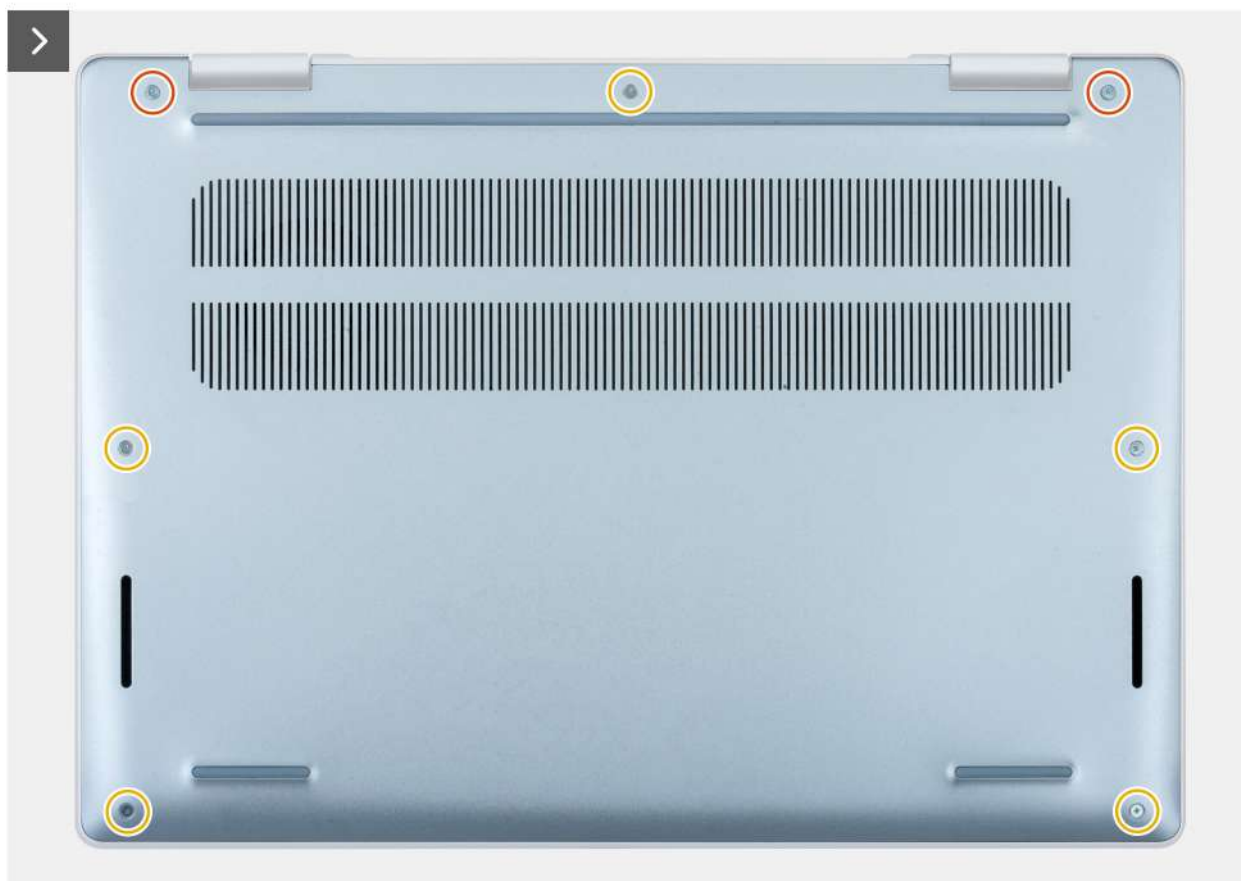
Rysunek 9. Wymontowywanie pokrywy dolnej
