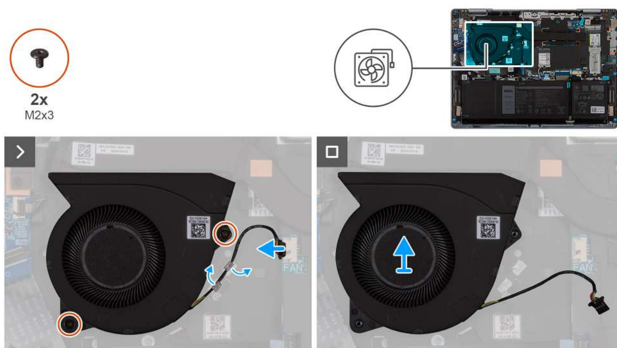
Rysunek 21. Wymontowywanie wentylatora
