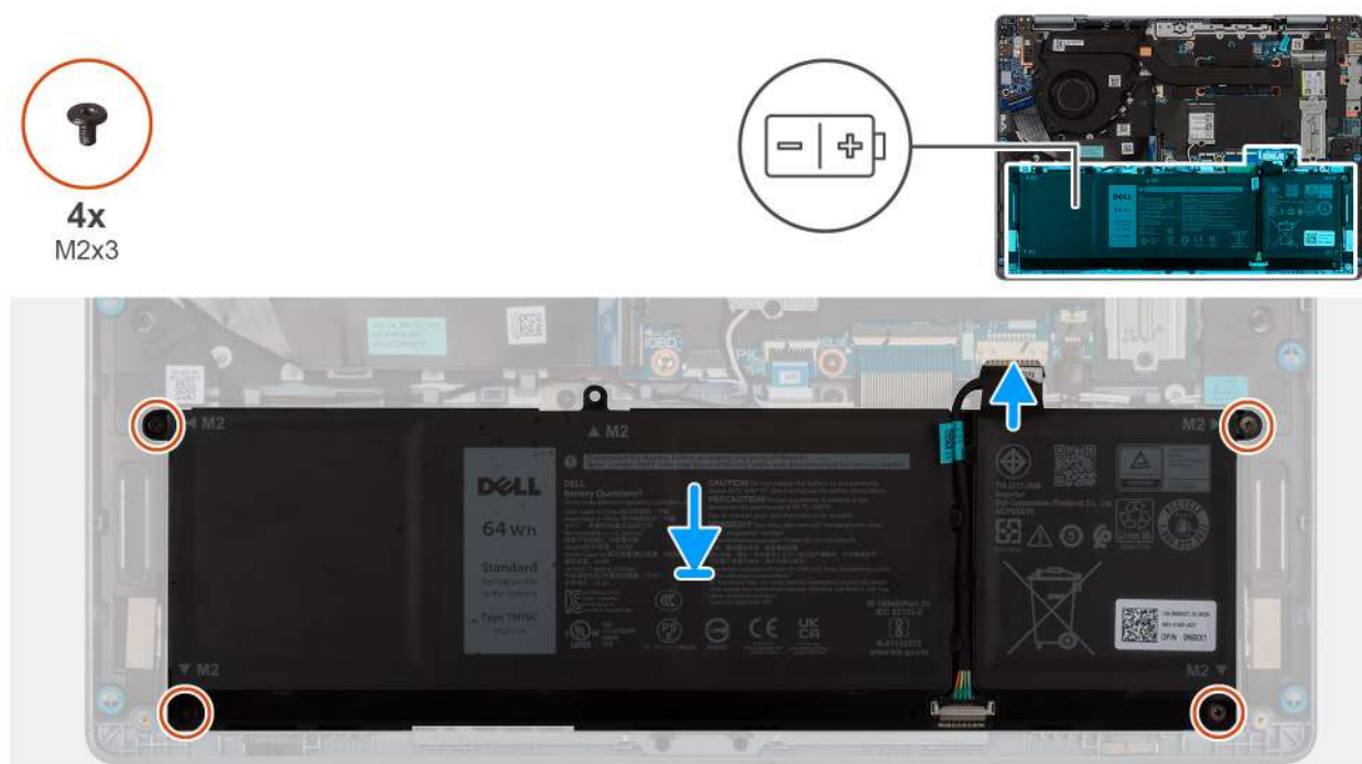
Rysunek 16. Instalowanie baterii
