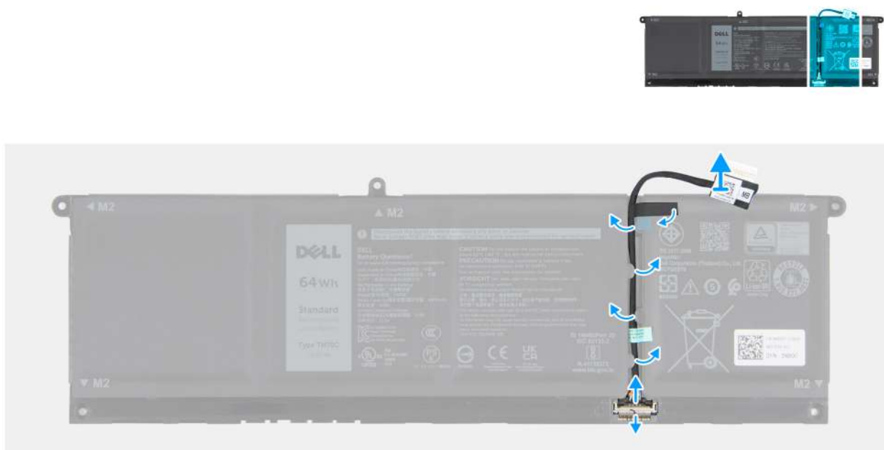
Rysunek 17. Wymontowywanie kabla baterii
