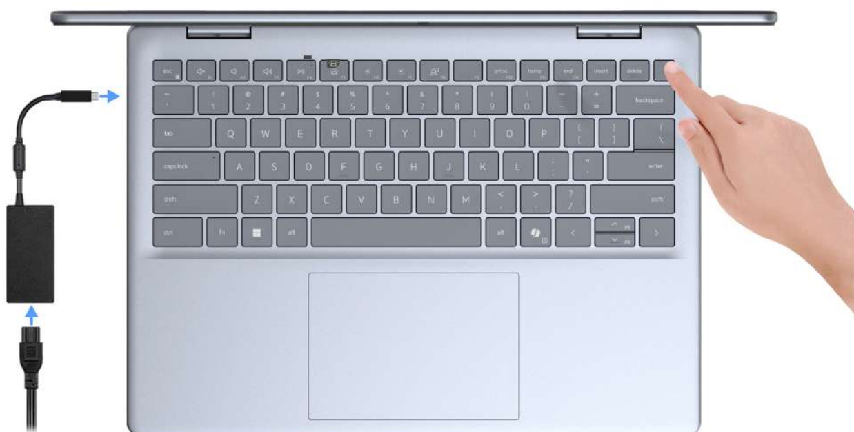
Rysunek 7. Podłącz zasilacz i naciśnij przycisk zasilania.
