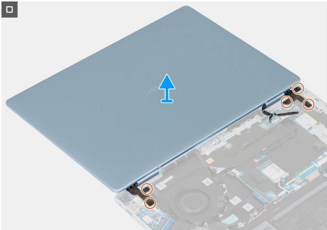
Rysunek 26. Wymontowywanie zestawu wyświetlacza — krok 2
