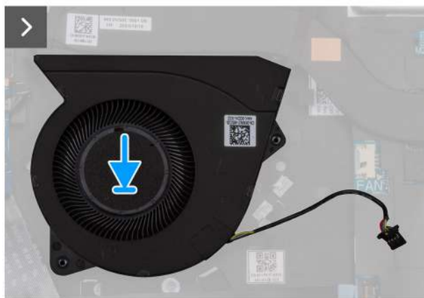
Rysunek 22. Instalowanie wentylatora
