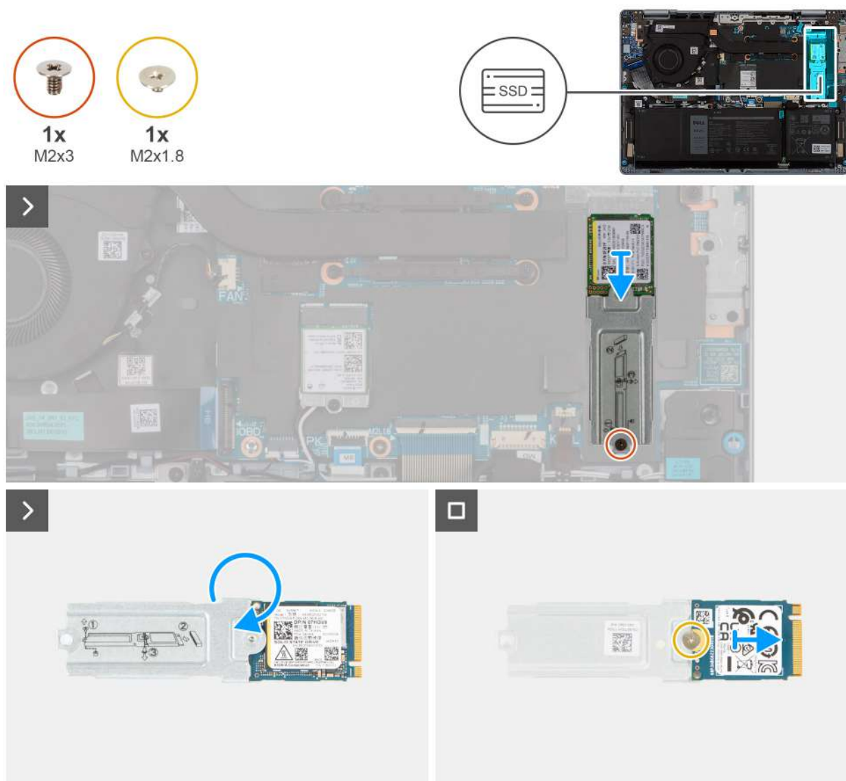
Rysunek 19. Wymontowywanie dysku SSD M.2 2230
