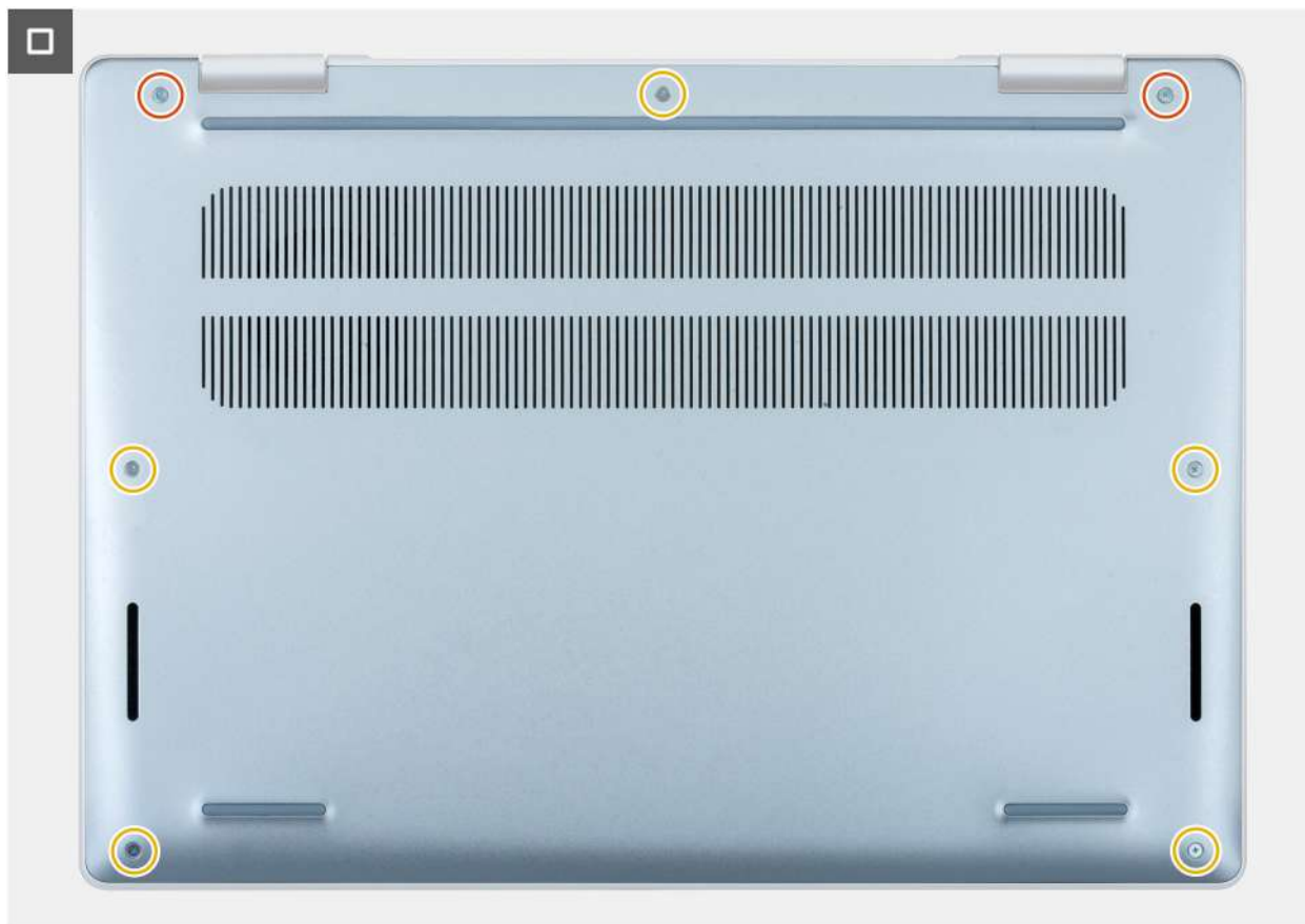
Rysunek 14. Instalowanie pokrywy dolnej
