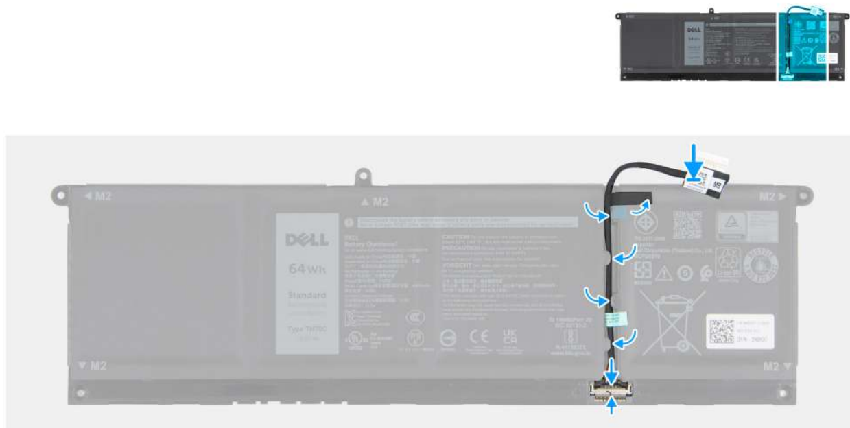
Rysunek 18. Instalowanie kabla baterii
