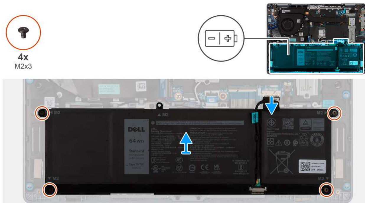
Rysunek 15. Wymontowywanie baterii
