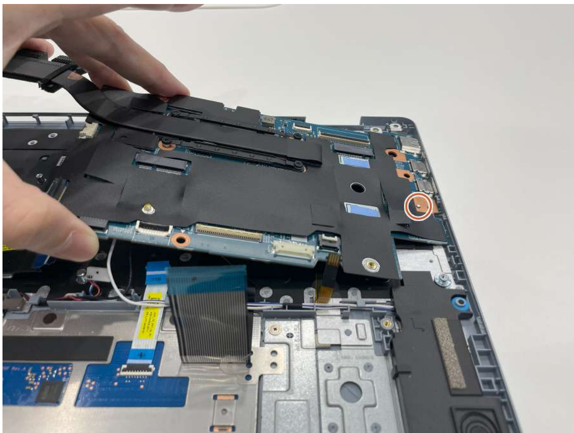
Rysunek 42. Wymontowywanie płyty głównej bez jej uszkodzenia
