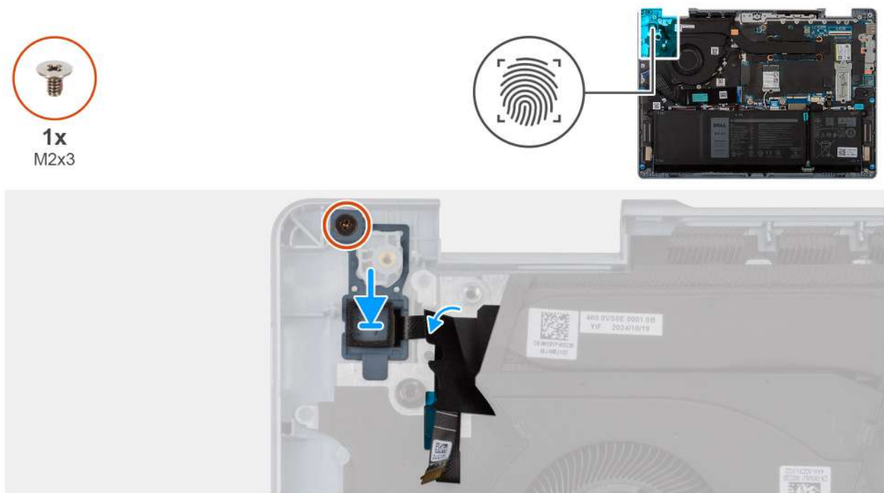
Rysunek 51. Instalowanie przycisku zasilania z czytnikiem linii papilarnych
