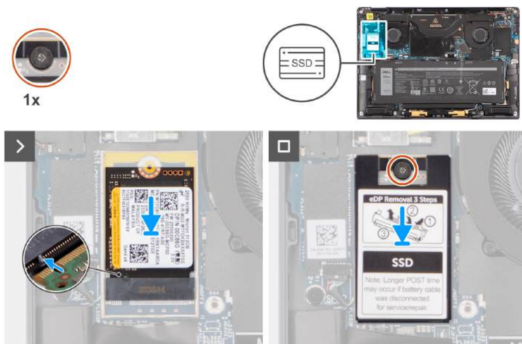
Rysunek 26. Instalowanie dysku SSD
