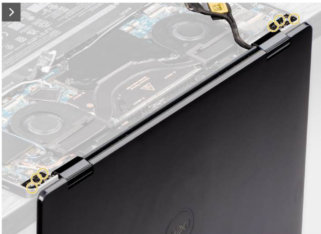
Rysunek 51. Instalowanie zestawu wyświetlacza
