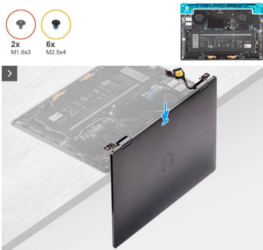
Rysunek 50. Instalowanie zestawu wyświetlacza
