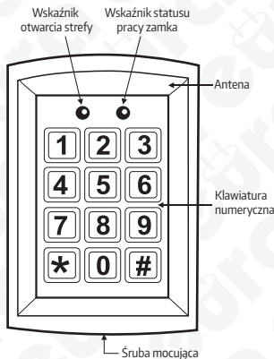
Rys.1. Budowa zamka szyfrowego AC-20C7
